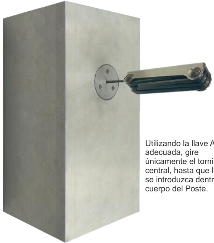
Utilizando la llave Allen adecuada, gire únicamente el tornillo central, hasta que la Tapa se introduzca dentro del cuerpo del Poste.
