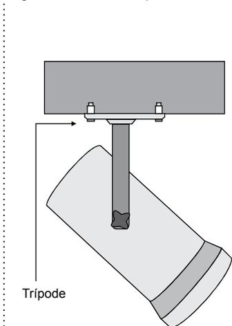
Fig.3 Instalación con Opresor [perro estructural]
