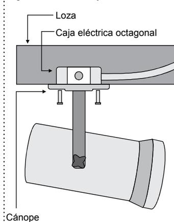
Fig.2 Instalación con Trípode
