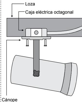
Fig.2 Instalación con Tripode
