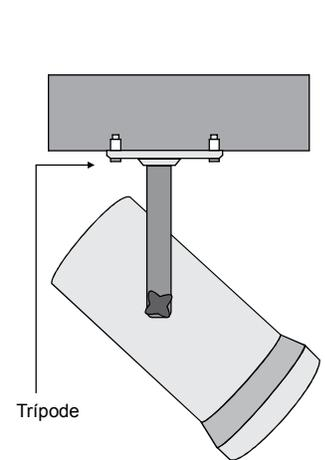
Fig.3 Instalación con Opresor [perro estructural]
