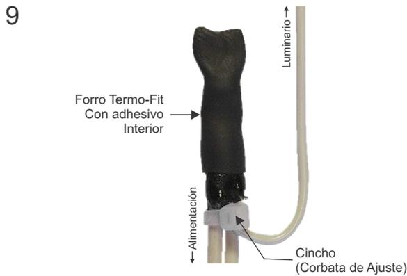
9 Aplique Calor con la Pistola de Aire Caliente hasta que la Pasta Dieléctrica comience a salir, solo debe de salir un poco. Después coloque un "Cincho", de modo que éste sujete los 3 cables. Tal como se muestra en la Imagen, el Cincho evitara que la conexión se abra al manipular esta para introducirla dentro de la Carcasa de Montaje.
