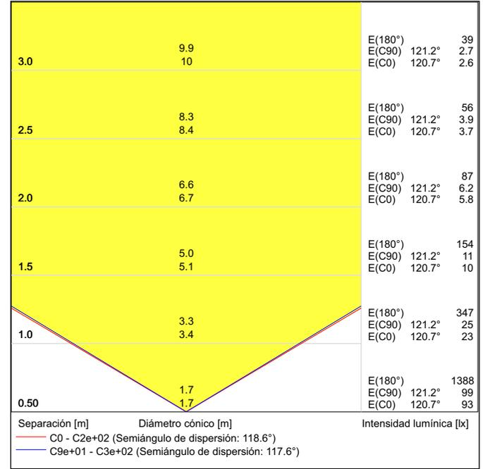
ISOLINEAS: BARRA 1.5 m; 14.67 W; 1,140 Lm; 3K, altura: 3 m
