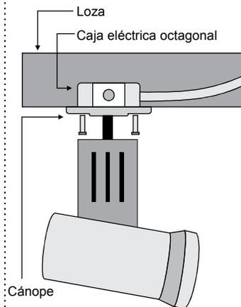
Fig.2 Instalación con Trípode
