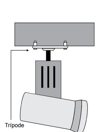
Fig.3 Instalación con Opresor [perro estructural]
