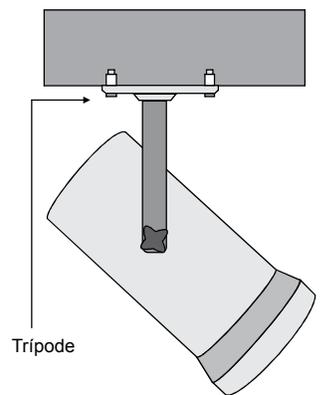
Fig.3 Instalación con Opresor [perro estructural]
