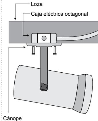
Fig.2 Instalación con Trípode
