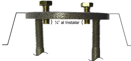
Al instalar el Ancla, coloque los 2 tornillos de sujeción, enrosquelos en la placa hasta que estos sobresalgan 1/4". Es recomendable, untar a la rosca de los tornillos alguna grasa o cera desmoldante.
