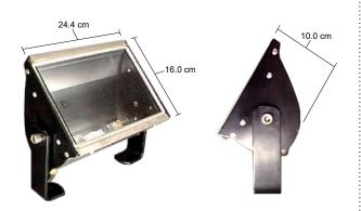
Luminario tipo: Proyector / Uso exterior. Material: Extrusión de Aluminio. Difusor: Cristal termotemplado. Tornillería: Acero Inox. Empague: Silicón moldeado Acabado: Pintura electrostática. Color Default: Negro liso. Base/Soquet: Rx7s24 (5K) Lámpara: HID T7 HQI de 150 W Balastro: De instalación remota.
